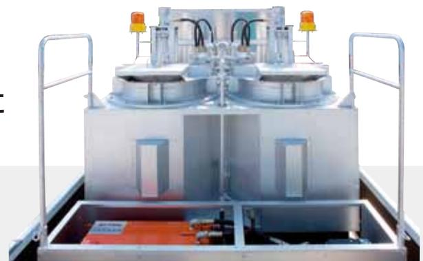
写真手前は材料を攪拌する油圧ユニット
