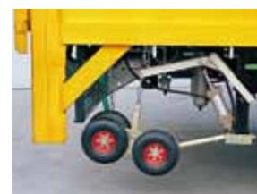
第5車輪の破線距離計
