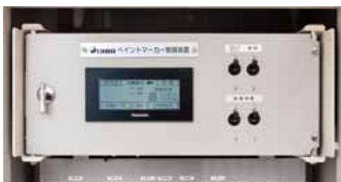
制御装置とタッチパネル式操作盤
