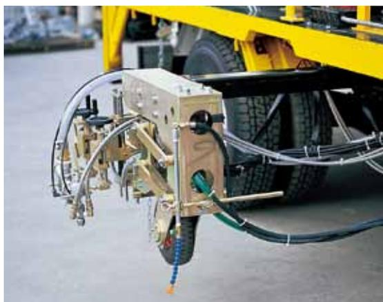
エンコーダー内蔵型ガンキャレッジは、第5車輪方式と違い、カーブ時の破線長さのバラツキは最小限です。また、バックギアで自動上昇します。
