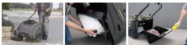
メインブラシが高速回転する「巻き上げ方式」で効率よくゴミを回収。メインブラシの交換やブラシ圧力の調節も工具無しで行えます。ダストコンテナは車輪付なので移動し易く時間短縮できます。
