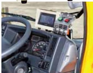
運転席左右操作盤タイプタッチパネル式と各種操作と表示機能付
