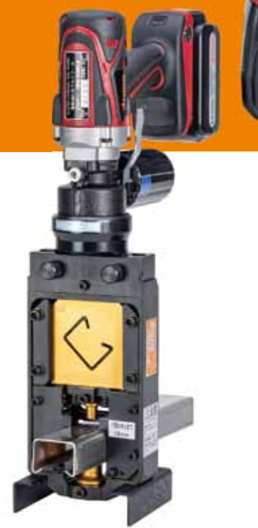
各種チャンネルの切断・穴あけ レースウェイカッター・パンチ
