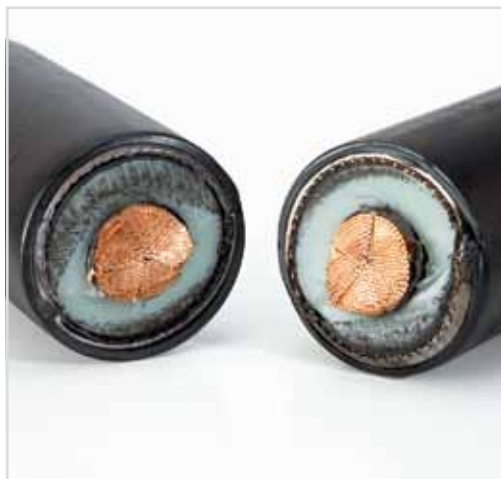
CR-150Cによるφ152mm電力ケーブル切断状況
